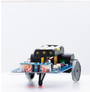
センサーを下向きに取付け床面を検知
